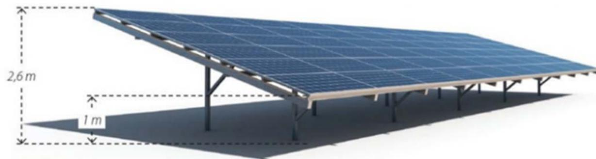
Figure 12 : Schéma des structures photovoltaïques (Source : EDF Renouvelables)
